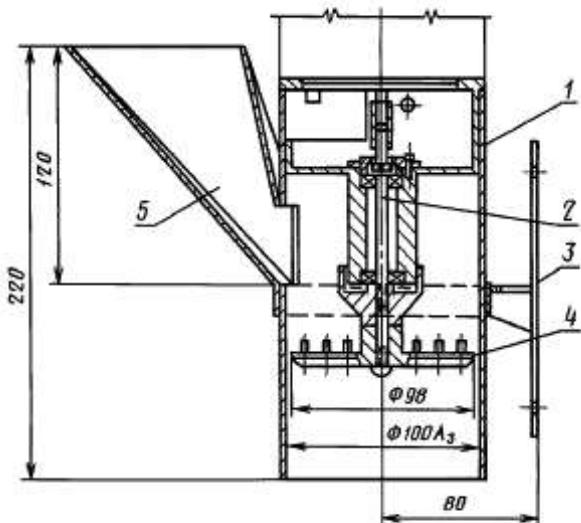
Фторопласт-4 подают небольшими порциями на вращающийся диск рыхлителя и сквозь зазор между корпусом и диском онсыпается в виде порошка в тару-приемник.
